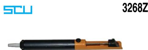
Tipo industriale. Per radio-tele-elettronica e circuiti stampati. Adatte per aspirare lo stagno dalle connessioni, per mezzo di un saldatore elettrico. Ugello in resina anaerobica (PTFE), corpo in alluminio, antistatico.
